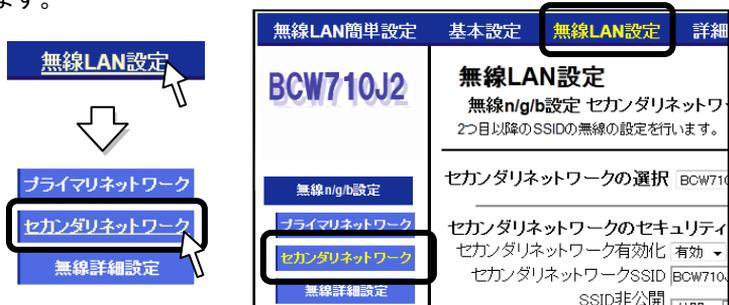
(5) 表示された画面の「セカンダリネットワークのセキュリティ設定」項目内のセカンダリネットワーク有効化について「有効」を選択し、セキュリティ「WEP」が選択されていることを確認の上、画面下部の「適用」ボタンをクリックします。
